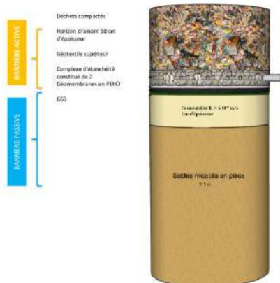
Figure 3 : Coupe des barrières de sécurité mises en œuvre dans le cadre du présent projet (source : Séché Eco-services)
